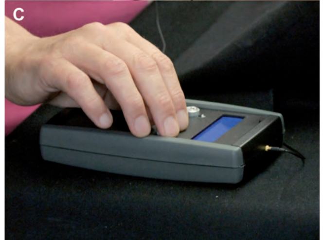
Fig 4: A) La fuente de alimentación externa es una caja con la bobina primaria. B) La bobina primaria está conectada magnéticamente detrás de la oreja con la bobina secundaria (debajo de la piel). La transferencia de energía entre las bobinas se da por la inducción electromagnética C) La configuración óptima de la percepción de acuerdo con los contrastes y la iluminación se hace por el/la paciente de forma manual en la caja de alimentación.
